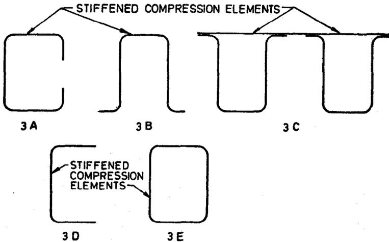
FIG. 3 STIFFENED COMPRESSION ELEMENTS
