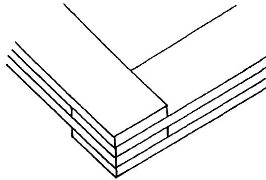
FIG. 4 DOUBLE-LAPPED JOINTS
