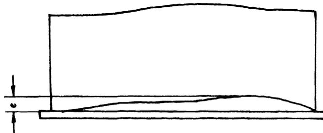
FIG. 19 VERIFICATION OF THE EDGE CAMBER
