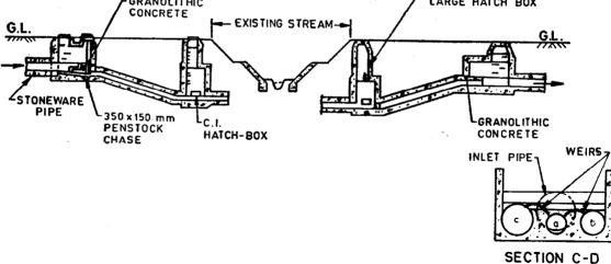
FIG. 1 TYPICAL INVERTED SYPHON
